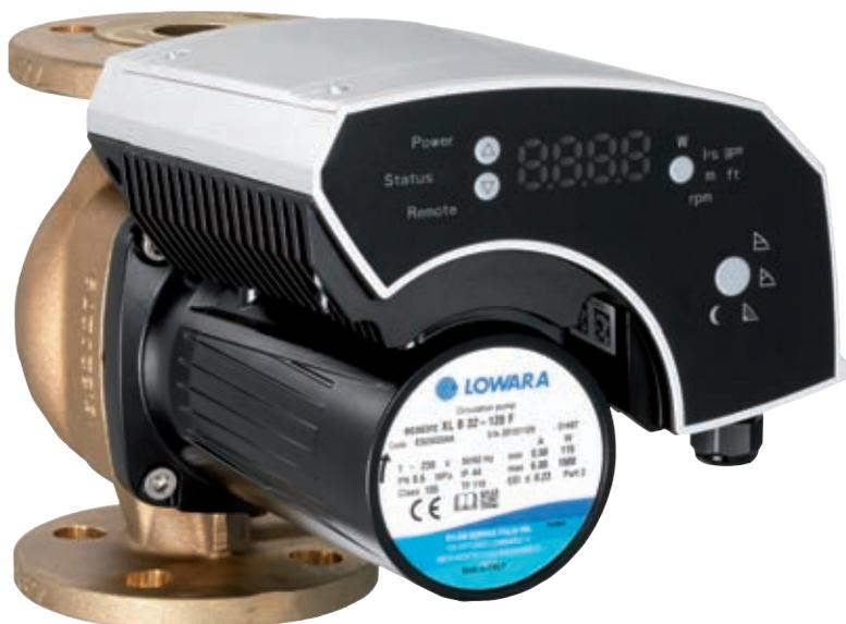
La pompa è un circolatore a rotore bagnato con motore di tipo sincrono commutato elettronicamente (tecnologia ECM) a magneti permanenti: ecocirc XL è a rotore sferico per i modelli 25-40, 25-60, 32-40, 32-60 ed è priva di albero e l'unica parte in movimento è il rotore/ girante. Per le altre versioni ecocirc XL è dotato di motore cilindrico. Tutti i componenti rotanti all'interno del motore cilindrico sono immersi nel liquido pompato che lubrifica i cuscinetti e raffredda il motore.
